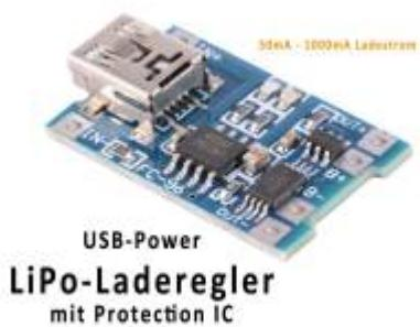
Mit diesem Laderegler können LiPo-Akkus mit einer Zelle geladen werden. Für den Betrieb sind keine weiteren Bauteile notwendig und die Baugruppe ist vollständig SMD bestückt (außer man möchte den voreingestellten Ladestrom verändern). Der Baustein verfügt über einen zusätzlichen IC zum Schutz der LiPo-Zelle gegen Überladung, Überstrom und Tiefentladung.
