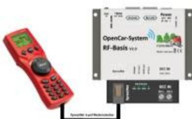
Die RF-Basis stellt dem Anwender ein Xpressnet Host zum Anschluss von Xpressnet Geräten zur Verfügung. Die mögliche Anzahl ist durch die 12V/500mA Stromversorgung des Buses auf ca. 5 Geräte begrenzt. Die Versorgungsspannung des Buses ist dabei kurzschlussfest ausgeführt. Mit am Bus angeschlossenen Handreglern können die Fahrzeuge gesteuert und per POM programmiert werden (Schreiben).
