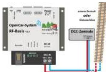
Vom DCC Eingang können die Fahrzeugdecoder mit 28 und 128 Fahrstufen-Fahrbefehlen, per Funktionsbefehl für die Funktionen F0 – 28 und per POM Programmierbefehlen (nur Schreiben) angesteuert werden. Decoderrückmeldungen werden nicht an die DCC Zentrale ausgegeben! Mit dieser Anschlussart besteht eine Funktionseinschränkung, weil keine Rück-Kommunikation möglich ist. Die DCC Funktionalität der RF-Basis steht nur zur Verfügung, wenn **keine BiDiB Verbindung** besteht!
