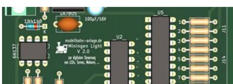
Für die digitale Steuerung der Modellbahn, z.B. mit TrainController, bedarf es an einiger Hardware, die Befehle ausführt, z.B. Weichen schaltet, Lichter schaltet, Signale stellt, ...
