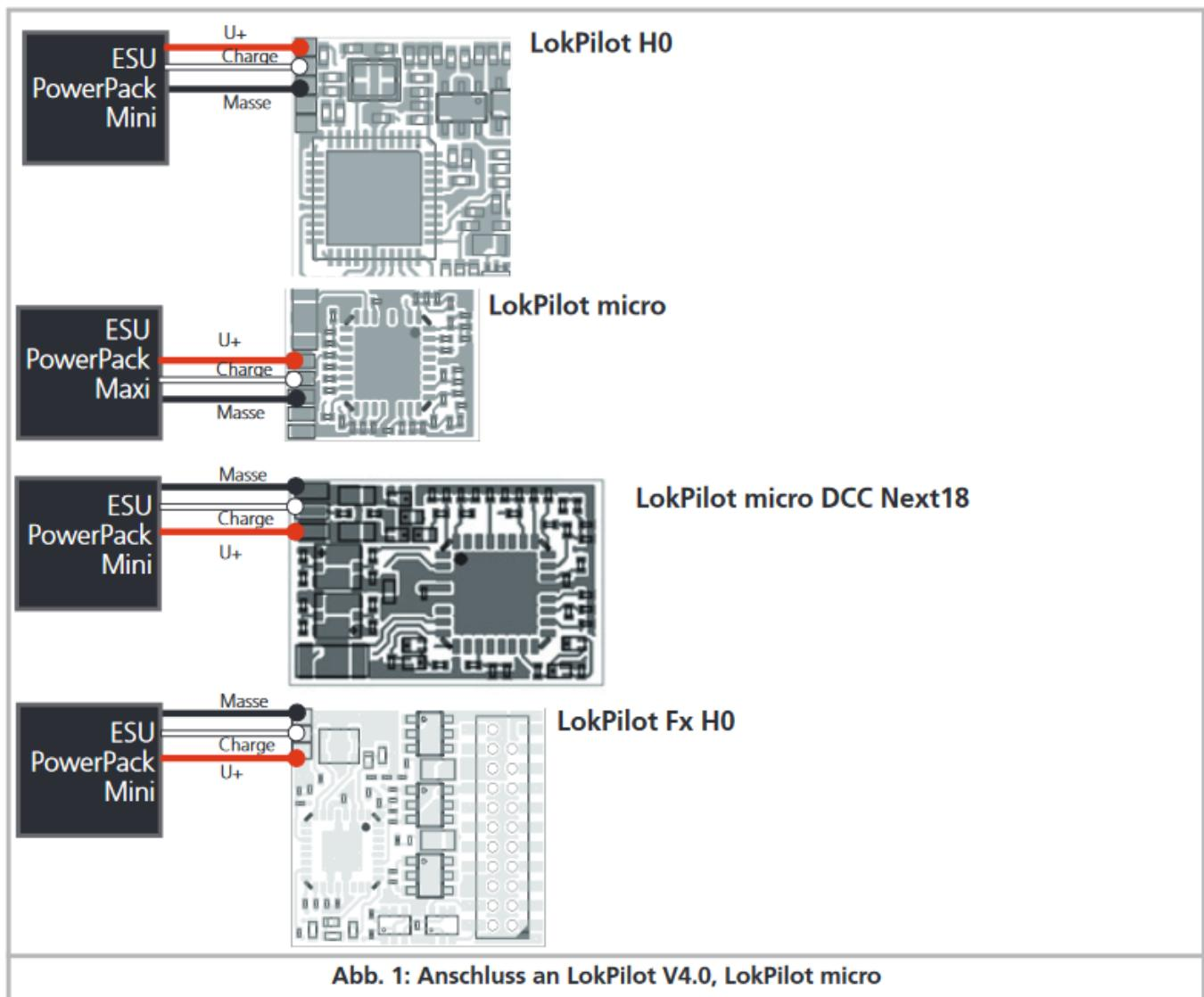
Abb. 1: Anschluss an LokPilot V4.0, LokPilot micro
