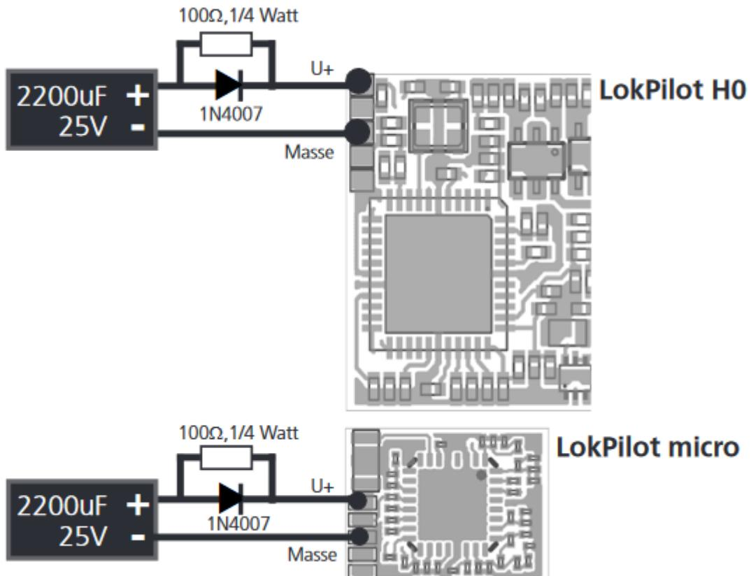
Anschluss des PowerPacks an einen ESU Lokpilot 4
