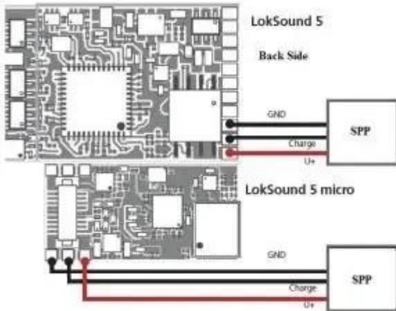
Anschluss des PowerPacks von Train-o-Matic an den ESU Lokpilot
