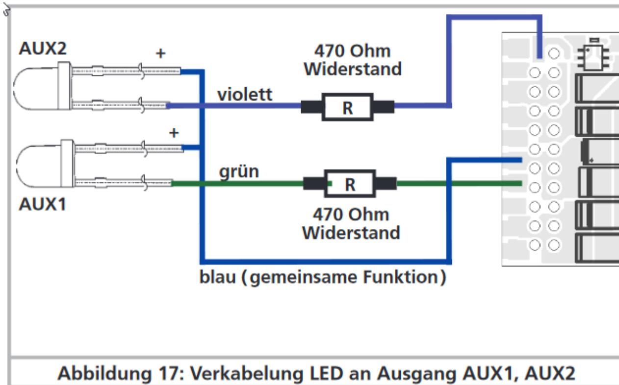
Bei SMD-LEDs wird also wie folgt angeschlossen:
