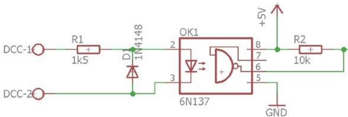
Schematische Darstellung der Elektronik für DCC zum Arduino
