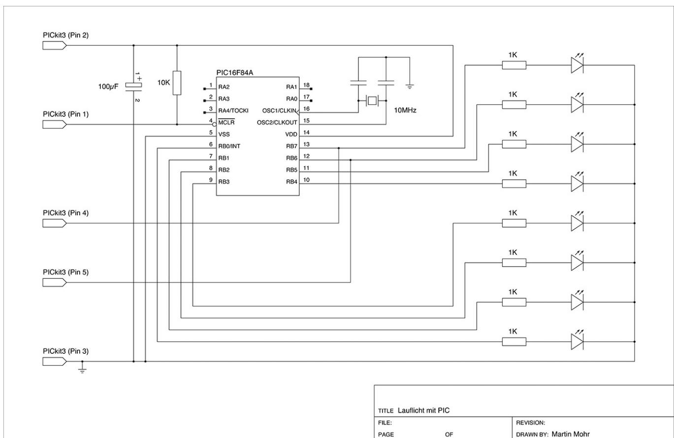
An den Eingängen OSC1 und OSC2 ist ein 10-MHz-Quarz angeschlossen. Die zwei Kondensatoren am Quarz sorgen dafür, dass der Quarz exakt auf seiner Frequenz schwingt. Die konkreten Werte müssen
