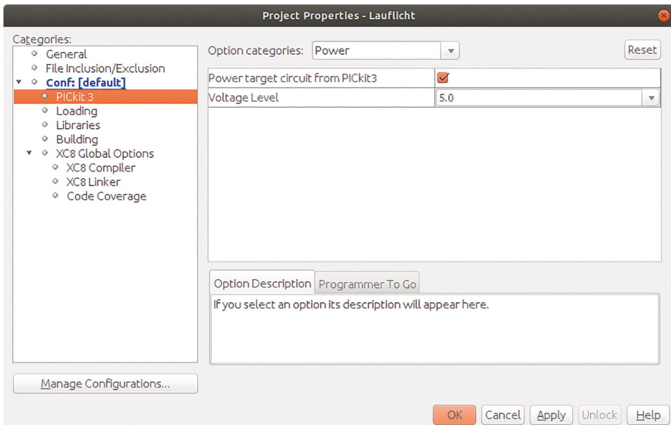
Um das Programm zu bauen und in den Controller zu laden, klicken Sie mit der rechten Maustaste auf das Projekt und wählen Run aus. Die IDE beginnt nun automatisch das Projekt zu bauen. Ist der Bau erfolgreich abgeschlossen, wird das Programm automatisch in den PIC16F84A geladen und dort gestartet. Alternativ zu Run können Sie auf den kaum zu übersehenden Button mit dem grünen Pfeil nach rechts klicken.
