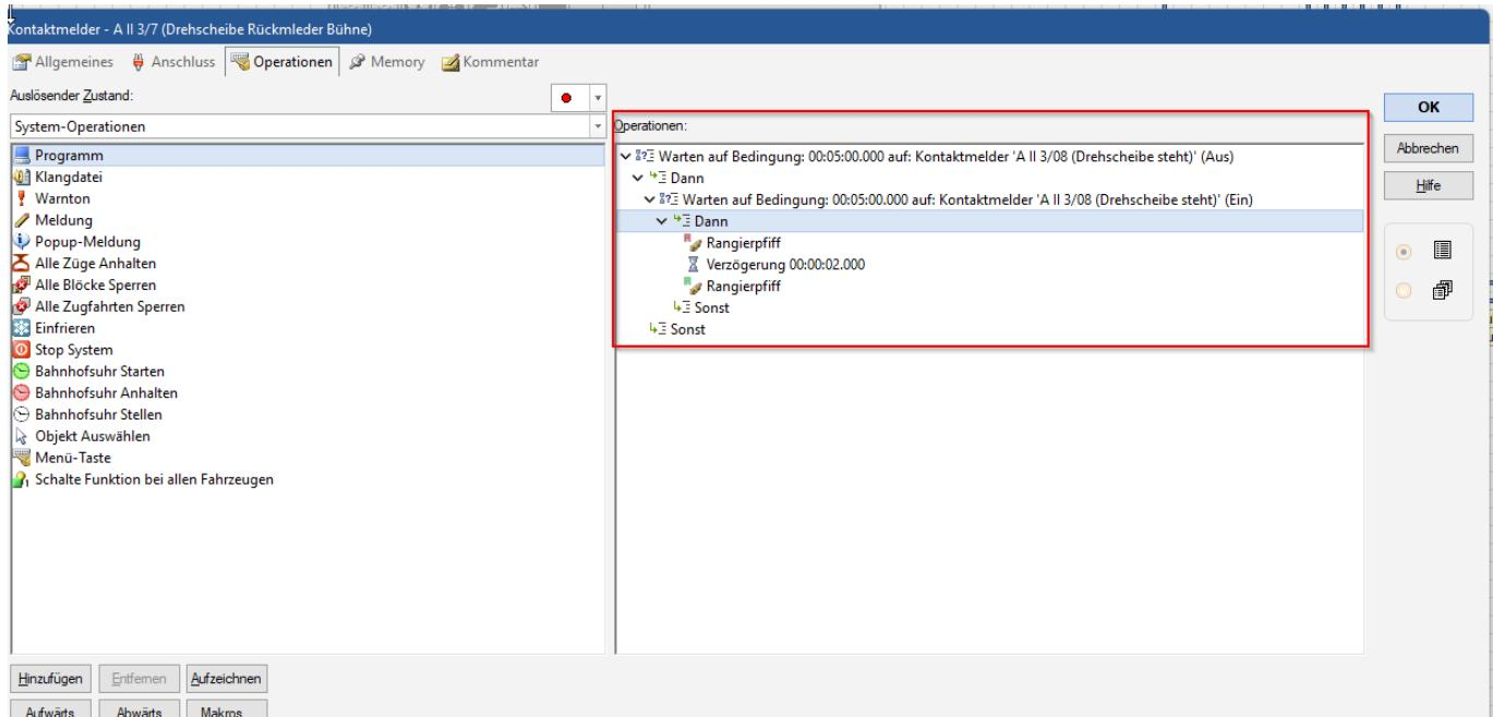
Unter den „Operationen“ wird ein Ablauf gebaut, der jede Lok den Rangierpiff auslösen lässt.
