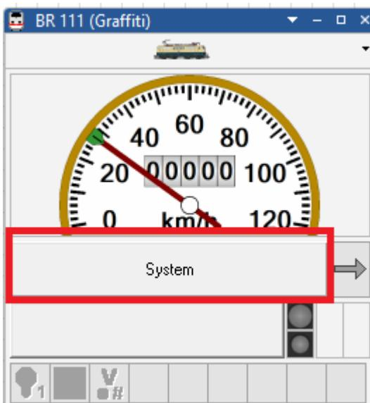
Dieser Button verhindert, dass mehrere die Lokomotive gleichzeitig steuern.
