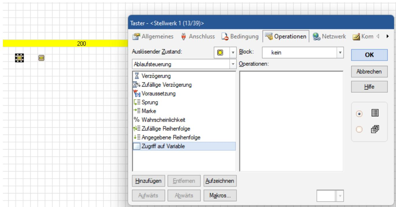
Durch den auslösenden Zustand in den Operationen definiert man, was beim Tasterdruck passieren soll - wir wählen hier „Zugriff auf Variable“.
