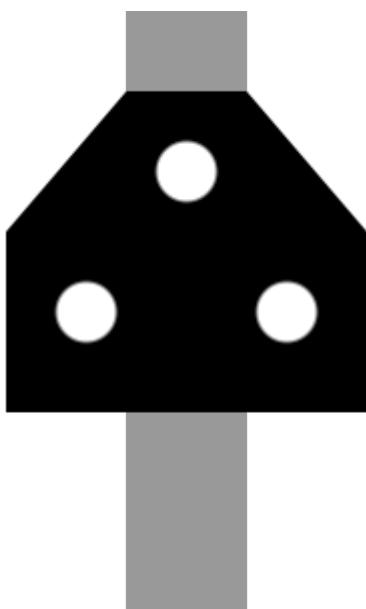
Es ordnet gemäß Signalbuch an: „Am Signal Hp 0 oder am gestörten Lichthauptsignal ohne schriftlichen Befehl vorbeifahren.“
