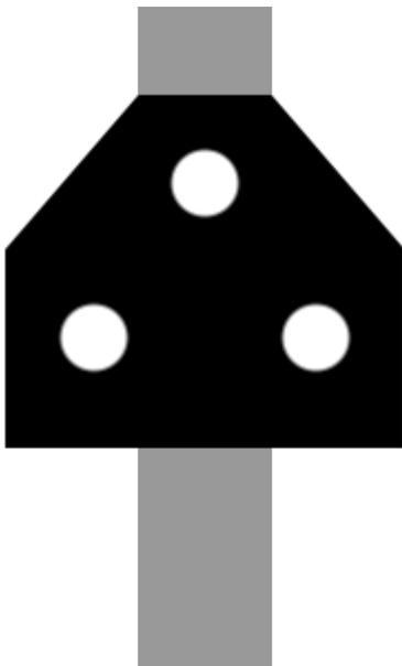
Das Ersatzsignal (Kurzbezeichnung Zs 1) ist ein Eisenbahnsignal aus der Gruppe der Zusatzsignale, das sich an Hauptsignalen befindet.
